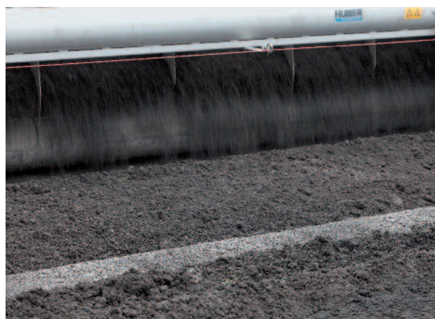
Mistura de arejamento do lodo por meio do revolvedor
