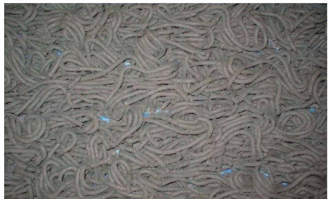
A camada de lodo porosa é movimentada lenta e cuidadosamente através do secador; a resistência mecânica e a formação de poeira são mínimos.
