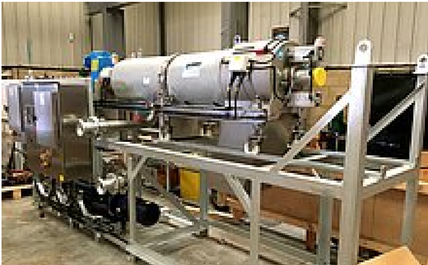
Fig. 5 - Planta de demostración premontada con bomba de alimentación y sistema de control
