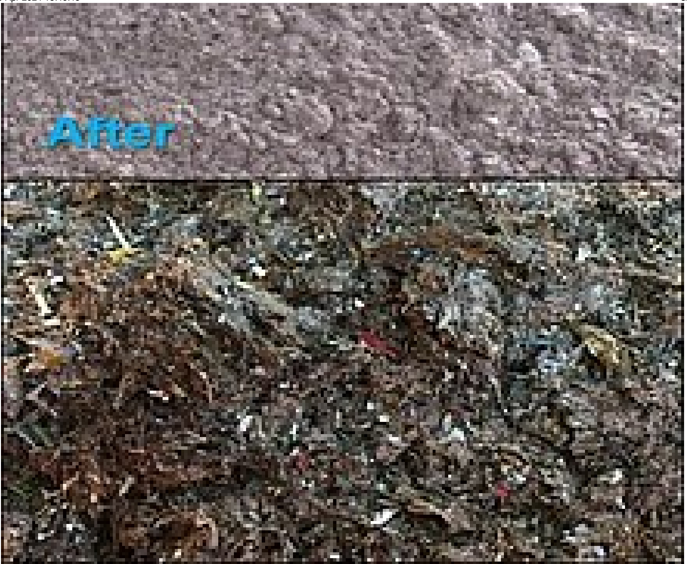
Fig. 3 - antes / después de STRAINPRESS® y criba
